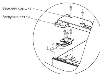
**6.7.** Замените верхнюю петлю на другую из комплекта поставки. Установите дверь холодильного отсека на среднюю петлю, затем установите верхнюю петлю. Соедините провода терминалов 1 и 4, 2 и 3. Установите заглушку для верхней петли и заглушку для отверстий.
